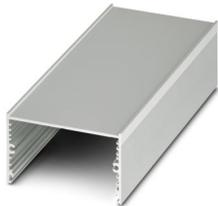
Caixa de perfil de extrusão, Montagem com parafusos, Cobertura de perfil, largura: 75,6 mm, largura de perfil (interna): 71,5 mm, largura de perfil (externa): 75,6 mm, comprimento: 165 mm, profundidade: 43,1 mm
