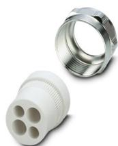
Prensa-cabos múltiplo Pg21, metálico, composto de borracha de vedação com várias perfurações (2 x 6 mm / 2 x 8 mm) e um parafuso de pressão, para suporte para cabos VC-M-KV-PG21...
