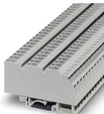
Borne de passagem, tensão nominal: 800 V, corrente nominal: 20 A, quantidade de conexões: 4, número de polos: 1, tipo de conexão: Conexão a parafuso / plugável, perfil de conexão: 0,2 mm<sup>2</sup> - 4 mm<sup>2</sup>, tipo de montagem: NS 35/7,5, NS 35/15, NS 32, cor: cinza
