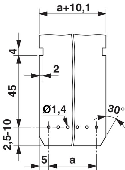
Esquema de pinagem/Geometria de pino de solda
