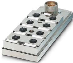
Caixa de distribuição, aplicação: Padrão, tipo de conexão: Conector M12 Metal, número de pontos de encaixe: 4, número de polos: 5, codificação: A, atribuição do ponto de encaixe: duplo, indicação de estado: não, Universal; conexão do cabo padrão: Conexão plugável M23 90°, blindagem: sim
