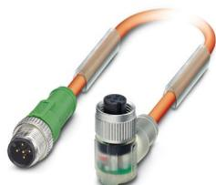
Cabo para sensor/atuador, 5-polos, PUR sem halogênio, reticulado por radiação, laranja RAL 2003, Conector reto M12, codificação: A, com 3 LEDs, para Soquete angular M12, codificação: A, com 3 LEDs, comprimento de cabo: 0,6 m, variante específica do cliente
