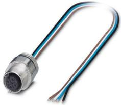
Conector de encaixe para equipamento parede frontal, Universal, 4-polos, Soquete, reto, M12-Padrão, A-codificação, para extremidade livre do condutor, Cabos individuais, comprimento de cabo: 0,5 m, 0,34 mm<sup>2</sup>, Cabo TPE, encapsulado, espera-se que esse artigo seja isento de chumbo a partir de 2025-Q4, de acordo com RoHS II, sem exceção 6c (Pb < 0,1%); alternativa sem chumbo possível mediante solicitação antecipada
