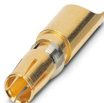
Contatos de energia, para elementos combinados D-SUB, soquete, pino de solda reto, corrente nominal 40 A, folheado a ouro
