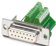
Contato fêmea D-SUB, tamanho de caixa 2, para 15 contatos de sinal, tipo de contato soquete, conexão a parafuso, reto, para quadro de montagem exterior e caixa do quadro móvel no grau de proteção IP67
