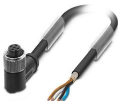
Cabo para sensor/atuador, 4-polos, PUR sem halogênio, preto acinzentado RAL 7021, blindado (Advanced Shielding Technology), extremidade livre do condutor, para Soquete angular M12, codificação: A, comprimento de cabo: 3 m
