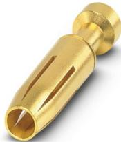
Contato para crimp, diâmetro de contato: 2,5 mm, Girado, Soquete, material de contato: Liga de cobre, superfície de contato: folheado a ouro, bitola de conexão: 4 mm<sup>2</sup> ... 4 mm<sup>2</sup>, AWG 12
