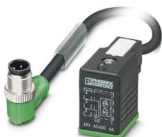
Cabo para sensor/atuador, 3-polos, PUR sem halogênio, preto acinzentado RAL 7021, Conector angular M12, codificação: A, com 1 LED, para Conector de válvula B (10 mm), com 1 LED, Ligação: Diodo Z, comprimento de cabo: 0,6 m
