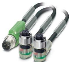
Cabo para sensor/atuador, 3-polos, PUR sem halogênio, preto acinzentado RAL 7021, Conector reto M12, codificação: A, para Soquete angular M12, codificação: A, com 2 LEDs, PIN 2+4 jumpeado e Soquete angular M12, codificação: A, com 2 LEDs, PIN 2+4 jumpeado, comprimento de cabo: 0,6 m
