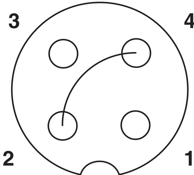
Imagem com pólos soquete M12, 3 pólos, PINO 2+4 jumpeado, codificação A, vista lado do soquete
