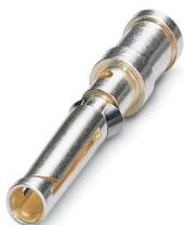
Contato para crimp, série: HC-M-12, Soquete, Girado, diâmetro de contato: 1,6 mm, bitola de conexão: 2,5 mm<sup>2</sup> ... 2,5 mm<sup>2</sup>, AWG 14...14 , material de contato: Liga de cobre
