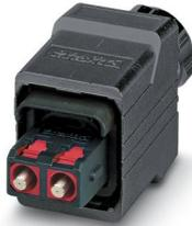
Conector de fibra óptica SC-RJ, IP67, com travamento Push-Pull, caixa de plástico, duplex, com tecnologia de conexão rápida, para fibra PCF 200/230  $\mu\text{m}$ , para diâmetro de condutor 2,2 mm, para diâmetro de cabo 6,5 mm ... 9,5 mm
