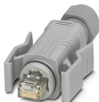
Conector RJ45, formato: RJ45, grau de proteção: IP67, número de polos: 8, 1 GBit/s, CAT5, material: Plástico, tipo de conexão: Conexão rápida IDC, bitola de conexão: AWG 26- 23, saída de cabo: reto, cor: cinza A RAL 7042, Ethernet
