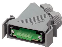
Conector de encaixe D-SUB, grau de proteção: IP67, número de polos: 5, material: Plástico, tipo de conexão: Conexão a parafuso, bitola de conexão: AWG 24- 12, saída de cabo: angular, DeviceNet™
