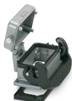
Caixa de montagem exterior B10, com trava simples, material: Alumínio fundido sob pressão, material capa de proteção: Al, altura: 29 mm, conexão para cabos: sem, tampa de proteção: sim, Padrão, com vedação plana
