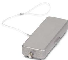
Tampa de proteção B24, para trava simples, material capa de proteção: Al, altura: 16 mm, vedação: não, com cordão de retenção
