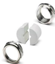
Conexão para cabo HEAVYCON M50 metálica, passagem de painel para conector de dados, com vedação parcial, diâmetro de furo 1 x 8 mm; vão livre 37 mm
