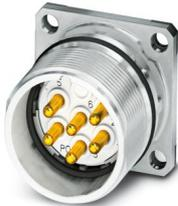
M23, Conector de encaixe para equipamento parede frontal, série: CA, reto, blindado: sim, para travamento padrão e SPEEDCON, Número de pólos: 7, Sentido de rotação: Padrão, tipo de contato: Pino, Conexão soldável, Junta plana, dimensões do flange: 25 mm x 25 mm, codificação: N, espera-se que esse artigo seja isento de chumbo a partir de 2025-Q3, de acordo com RoHS II, sem exceção 6c (Pb < 0,1%); alternativa sem chumbo possível mediante solicitação antecipada
