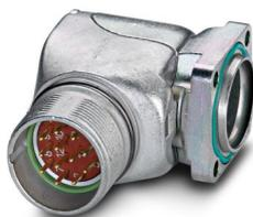
Conector de encaixe para equipamento parede frontal, angular fixo, Travamento parafusado, M23, número de polos: 16, tipo de contato: Pino, Anel de vedação radial, 4x Ø 3,2, blindado: sim, dimensões do flange: 26 mm x 26 mm, número de polos: 16, tipo de conexão: Conexão para crimp, série: RF
