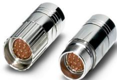
Conector para acoplamentos, reto, Travamento parafusado, M23, número de polos: 16, tipo de contato: Pino, blindado: sim, faixa de diâmetro de cabo: 6 mm ... 10 mm, número de polos: 16, tipo de conexão: Conexão para crimp, série: RF, Produto alternativo conforme RoHS II sem exceção 6c (Pb < 0,1 %) código: 1242818
