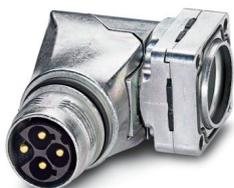
Conector de encaixe para equipamento parede frontal, angular, giratório, SPEEDCON, M17, número de polos: 6+PE, tipo de contato: Pino, Anel de vedação radial, 4x Ø 2,7 mm, blindado: sim, dimensões do flange: 25 mm x 25 mm, número de polos: 7, tipo de conexão: Conexão para crimp, série: ST
