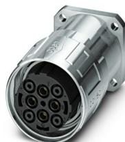
Conector de encaixe de parede frontal com porca serrilhada, reto, SPEEDCON, M40, número de polos: 4+3+PE, tipo de contato: Soquete, Anel de vedação radial, blindado: sim, dimensões do flange: 40 mm x 40 mm, número de polos: 8, tipo de conexão: Conexão para crimp, série: SM, espera-se que esse artigo seja isento de chumbo a partir de 2026-Q2, de acordo com RoHS II, sem exceção 6c (Pb < 0,1%); alternativa sem chumbo possível mediante solicitação antecipada
