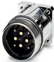
Conector de encaixe para equipamento parede frontal, reto, para travamento padrão e SPEEDCON, M40, número de polos: 4+3+PE, tipo de contato: Pino, Anel de vedação radial, blindado: sim, dimensões do flange: 40 mm x 40 mm, número de polos: 8, tipo de conexão: Conexão para crimp, série: SM, espera-se que esse artigo seja isento de chumbo a partir de 2026-Q2, de acordo com RoHS II, sem exceção 6c (Pb < 0,1%); alternativa sem chumbo possível mediante solicitação antecipada
