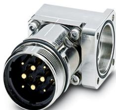
Conector de encaixe para equipamento parede frontal, angular fixo para cargas elevadas, SPEEDCON, M40, número de polos: 4+3+PE, tipo de contato: Pino, Anel de vedação radial, blindado: sim, dimensões do flange: 40 mm x 40 mm, número de polos: 8, tipo de conexão: Conexão para crimp, série: SM, espera-se que esse artigo seja isento de chumbo a partir de 2026-Q2, de acordo com RoHS II, sem exceção 6c (Pb < 0,1%); alternativa sem chumbo possível mediante solicitação antecipada
