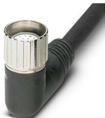
Cabo padrão, aplicação: Caixa de sensor/atuador, número de polos: 19, atribuição do ponto de encaixe: duplo, indicação de estado: não; conexão do cabo padrão: Conexão plugável M23, PUR/PVC, comprimento do cabo: 20 m, blindagem: não, espera-se que esse artigo seja isento de chumbo a partir de 2025-Q4, de acordo com RoHS II, sem exceção 6c (Pb < 0,1%); alternativa sem chumbo possível mediante solicitação antecipada
