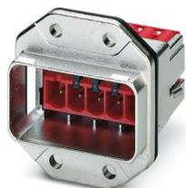
Quadro de montagem exterior MSTB, IP67, para travamento push-pull, metal, com contato fêmea integrado para conexão de condutor, conexão à mola, 400 V, para recorte de montagem retangular, com vedação, sem parafusos de fixação
