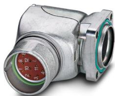
Conector de encaixe para equipamento parede frontal, angular fixo, Travamento parafusado, M23, número de polos: 17, tipo de contato: Soquete, Anel de vedação radial, 4x Ø 3,2, blindado: sim, dimensões do flange: 28 mm x 28 mm, número de polos: 17, tipo de conexão: Conexão para crimp, série: RF
