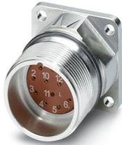
Conector de encaixe para equipamento parede frontal, reto, Travamento parafusado, M23, número de polos: 17, tipo de contato: Pino, Anel de vedação radial, blindado: sim, número de polos: 17, tipo de conexão: Conexão para crimp, série: RF
