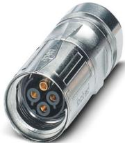
Conector para cabos, reto, SPEEDCON, M17, número de polos: 5+PE, tipo de contato: Soquete, blindado: sim, grau de proteção: IP67, faixa de diâmetro de cabo: 5 mm ... 8 mm, número de polos: 6, tipo de conexão: Conexão para crimp, série: ST, espera-se que esse artigo seja isento de chumbo a partir de 2025-Q3, de acordo com RoHS II, sem exceção 6c (Pb < 0,1%); alternativa sem chumbo possível mediante solicitação antecipada
