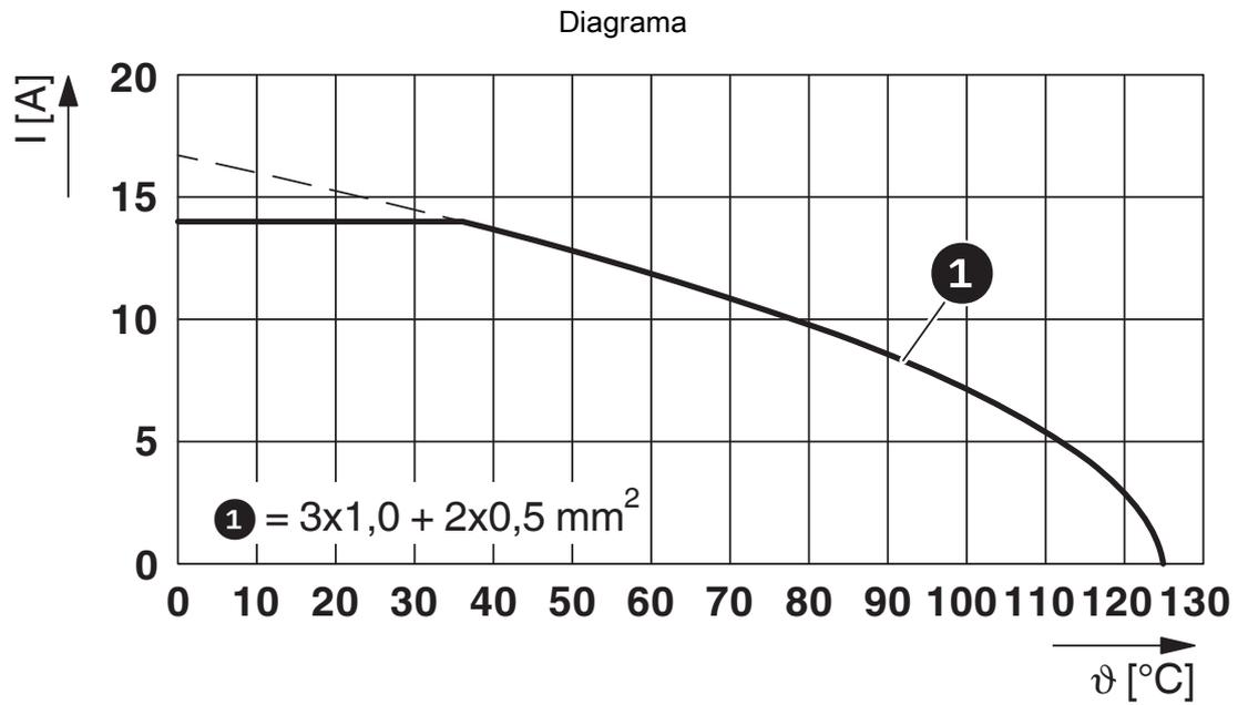
$I$  = intensidade de corrente,  $\vartheta$  = temperatura ambiente, 3 x 14 A + 2x 2 A constante
