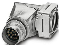
Conector de encaixe para equipamento parede frontal, angular, giratório, SPEEDCON, M17, número de polos: 17, tipo de contato: Soquete, Anel de vedação radial, 4x Ø 2,7 mm, blindado: sim, dimensões do flange: 25 mm x 25 mm, número de polos: 17, tipo de conexão: Conexão para crimp, série: ST
