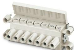
Inserto de contato, Família de artigos: VARIOCON, formato: VC4, cor: cinza claro, número de polos: 7, bitola do condutor mín.: 0,5 mm<sup>2</sup>, bitola do condutor máx.: 16 mm<sup>2</sup>, corrente nominal: 70 A, Tipo de conexão: Conexão a parafuso, Conectores podem ser acionados somente sem tensão.
