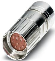
Conector para cabos, reto, Travamento parafusado, M23, número de polos: 17, tipo de contato: Soquete, blindado: sim, grau de proteção: IP67, faixa de diâmetro de cabo: 6 mm ... 10 mm, número de polos: 17, tipo de conexão: Conexão para crimp, série: RF, espera-se que esse artigo seja isento de chumbo a partir de 2026-Q3, de acordo com RoHS II, sem exceção 6c (Pb < 0,1%); alternativa sem chumbo possível mediante solicitação antecipada
