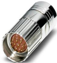
Conector para cabos, reto, Travamento parafusado, M23, número de polos: 12, tipo de contato: Pino, blindado: sim, faixa de diâmetro de cabo: 6 mm ... 10 mm, número de polos: 12, tipo de conexão: Conexão para crimp, série: RF, Produto alternativo conforme RoHS II sem exceção 6c (Pb < 0,1 %) código: 1242248
