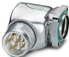
Conector de encaixe para equipamento parede frontal, angular fixo, Travamento parafusado, M23, número de polos: 4+3+PE, tipo de contato: Pino, Anel de vedação radial, blindado: sim, dimensões do flange: 26 mm x 26 mm, faixa de diâmetro de cabo: 0 mm ... 0 mm, número de polos: 8, tipo de conexão: Conexão para crimp, série: SF
