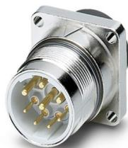
Conector de encaixe para equipamento parede frontal, formato reto baixo, Travamento parafusado, M23, número de polos: 5+PE, tipo de contato: Pino, Anel de vedação radial, blindado: sim, dimensões do flange: 28 mm x 28 mm, faixa de diâmetro de cabo: 0 mm ... 0 mm, número de polos: 6, tipo de conexão: Conexão para crimp, série: SF
