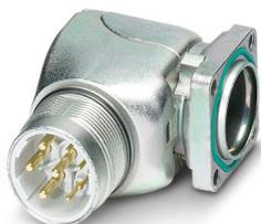
Conector de encaixe para equipamento parede frontal, angular, rotativo, dimensão do flange aumentada, Travamento parafusado, M23, número de polos: 5+PE, tipo de contato: Pino, Anel de vedação radial, blindado: sim, dimensões do flange: 28 mm x 28 mm, Compatível com conectores acoplados com porca serrilhada SPEEDCON ou M23 padrão, número de polos: 6, tipo de conexão: Conexão para crimp, série: SF
