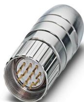
M23, Conector para cabos, série: UC, reto, blindado: sim, Travamento parafusado, Número de pólos: 16+3, Sentido de rotação: Padrão, tipo de contato: Pino, Cálice de solda, faixa de diâmetro de cabo: 2 mm ... 14,5 mm, codificação: N
