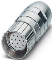
M23, Conector para cabos, série: UC, reto, blindado: sim, Travamento parafusado, Número de pólos: 17, Sentido de rotação: Padrão, tipo de contato: Soquete, Cálice de solda, faixa de diâmetro de cabo: 2 mm ... 14,5 mm, codificação: N
