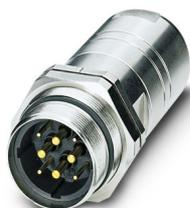
Passagem parede posterior, reto, longo, Travamento parafusado, M40, número de polos: 4+3+PE, tipo de contato: Pino, Anel de vedação radial, Fixação central, blindado: sim, faixa de diâmetro de cabo: 9 mm ... 12,5 mm, número de polos: 8, tipo de conexão: Conexão para crimp, série: SM
