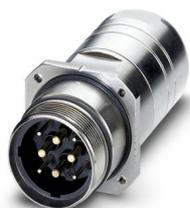
Passagem parede posterior, reto curto, Travamento parafusado, M40, número de polos: 4+3+PE, tipo de contato: Pino, Anel de vedação radial, blindado: sim, faixa de diâmetro de cabo: 9 mm ... 12,5 mm, número de polos: 8, tipo de conexão: Conexão para crimp, série: SM, espera-se que esse artigo seja isento de chumbo a partir de 2027-Q1, de acordo com RoHS II, sem exceção 6c (Pb < 0,1%); alternativa sem chumbo possível mediante solicitação antecipada
