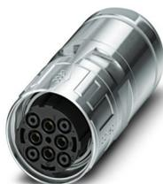
Conector para cabos, reto, longo, SPEEDCON, M40, número de polos: 2+3+PE, tipo de contato: Soquete, blindado: sim, faixa de diâmetro de cabo: 14 mm ... 20,5 mm, número de polos: 6, tipo de conexão: Conexão para crimp, série: SM
