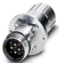
Passagem de parede, pino/soquete, reto, M40, M40, número de polos: 2+3+PE, tipo de contato: Soquete, Anel de vedação radial, 4xØM4, blindado: sim, faixa de diâmetro de cabo: 0 mm ... 0 mm, número de polos: 6, tipo de conexão: Conexão para crimp, série: SM
