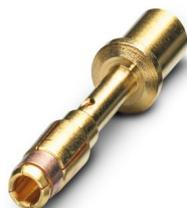
Contato para crimp, Soquete, Girado, diâmetro de contato: 2 mm, bitola de conexão: 4 mm<sup>2</sup> ... 4 mm<sup>2</sup>, material de contato: CuZn , Produto alternativo conforme RoHS II sem exceção 6c (Pb < 0,1 %) código: 1241949
