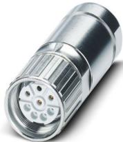
Conector para cabos, reto, longo, Travamento parafusado, M23, número de polos: 4+3+PE, tipo de contato: Soquete, blindado: sim, grau de proteção: IP67, faixa de diâmetro de cabo: 7,5 mm . .. 9 mm, número de polos: 8, tipo de conexão: Conexão para crimp, série: SF, espera-se que esse artigo seja isento de chumbo a partir de 2026-Q1, de acordo com RoHS II, sem exceção 6c (Pb < 0,1%); alternativa sem chumbo possível mediante solicitação antecipada
