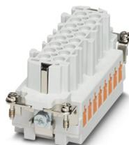
Inserto de contato, número de polos: 16+PE, tamanho: B16, Soquete, Conexão QUICKON, 500 V, 16 A, 0,34 mm<sup>2</sup> ... 2,5 mm<sup>2</sup>
