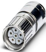
Conector para cabos, reto curto, Travamento parafusado, M23, número de polos: 5+PE, tipo de contato: Soquete, blindado: sim, grau de proteção: IP67, faixa de diâmetro de cabo: 9 mm ... 11 mm, número de polos: 6, tipo de conexão: Conexão para crimp, série: SF, espera-se que esse artigo seja isento de chumbo a partir de 2027-Q1, de acordo com RoHS II, sem exceção 6c (Pb < 0,1%); alternativa sem chumbo possível mediante solicitação antecipada
