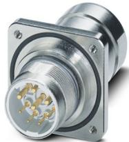
Passagem parede posterior, reto, Travamento parafusado, M23, número de polos: 5+PE, tipo de contato: Pino, Anel de vedação radial, blindado: sim, faixa de diâmetro de cabo: 7,5 mm ... 14 mm, número de polos: 6, tipo de conexão: Conexão para crimp, série: SF, espera-se que esse artigo seja isento de chumbo a partir de 2027-Q1, de acordo com RoHS II, sem exceção 6c (Pb < 0,1%); alternativa sem chumbo possível mediante solicitação antecipada
